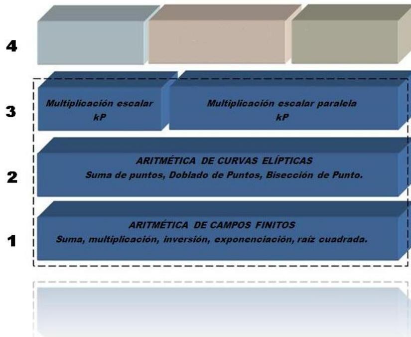
Figura 1.1: Modelo de la arquitectura en la que se basa la implementación.
