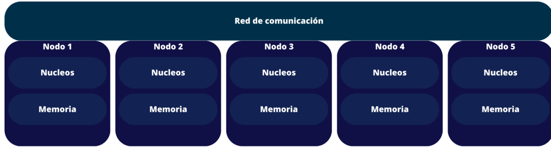
Figura 3.3: Cluster con 5 nodos interconectados.
